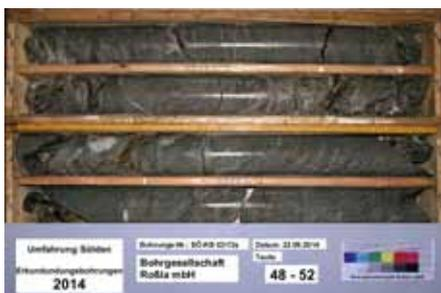
Bohrkern aus dem Felsbereich (tunnelbautechnisch ideale Verhältnisse)
